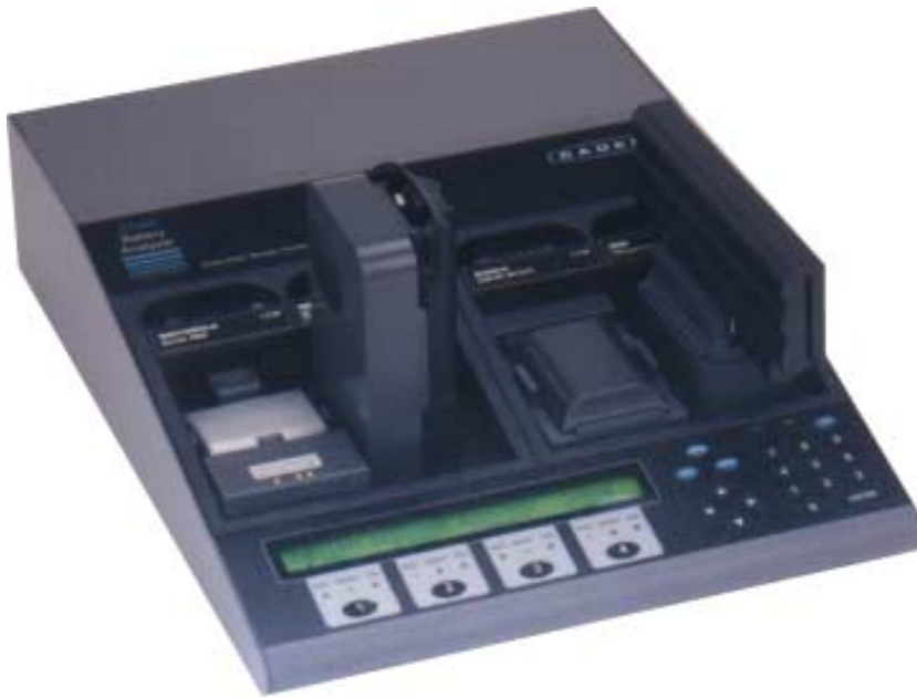
Figura 4: El analizador de baterías serie C7000 puede medir los m\Omega como parte de una prueba rápida de baterías o ser incluida en el programa de reacondicionamiento.
